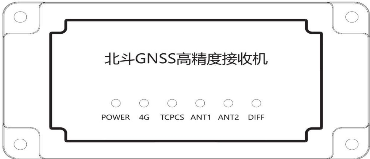
**POWER 灯：**电源状态灯，设备正常运行时闪烁；作为基准值没有设置固定位置时，常亮；作为流动站，没有设置基础位置时，常亮；
